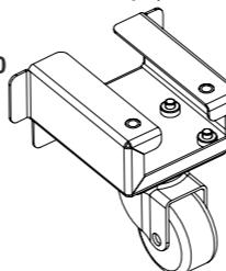
Внимание! Шкаф с установленными роликами должен перемещаться только по ровной поверхности, при заказе учитывайте нагрузочную способность роликов.
